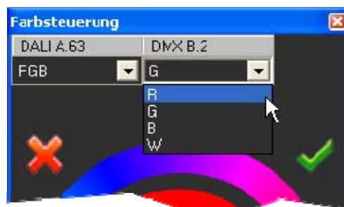
Farbsteuerung mit zusätzlicher Auswahl von Leuchten / Farbkanälen (Ausschnitt)
